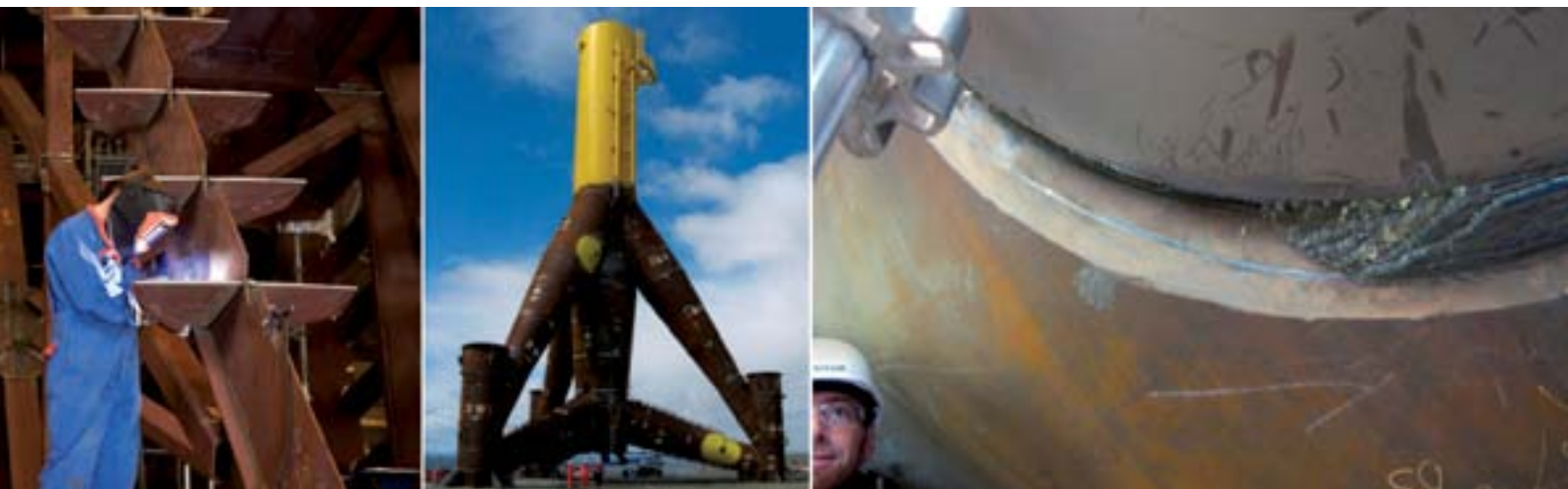
Опорные конструкции ветроэнергетической установки Multibrid M5000. Масса: 700 т, марка стали: S355, диаметр труб магистрального трубопровода: 4000-6000 мм, диаметр труб ответвлений трубопровода: 2000-4500 мм, толщина стенок труб магистрального трубопровода: 90 мм, толщина стенок труб ответвлений трубопровода: 30-40 мм
